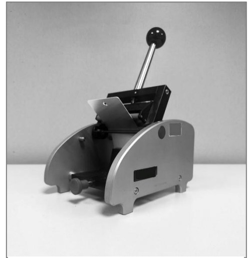
图片 5 - 弯曲抗开裂测试装置
